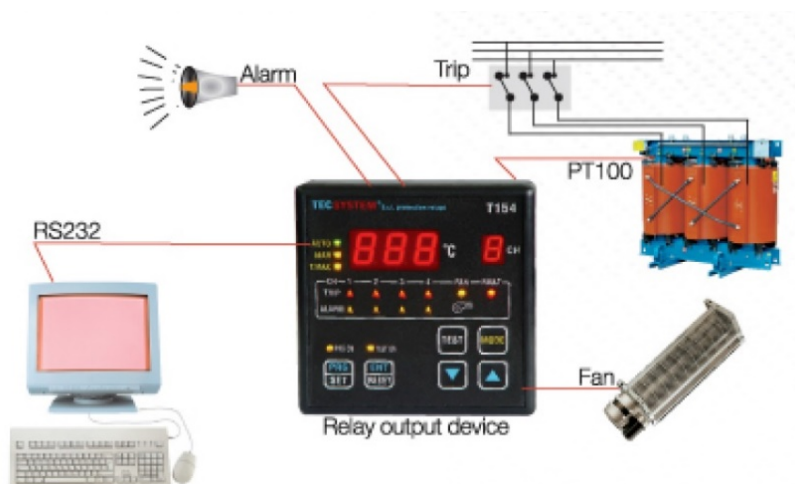
شکل ۸-۱۹- رله ترمومتر دیجیتالی ترانسفورماتور خشک
