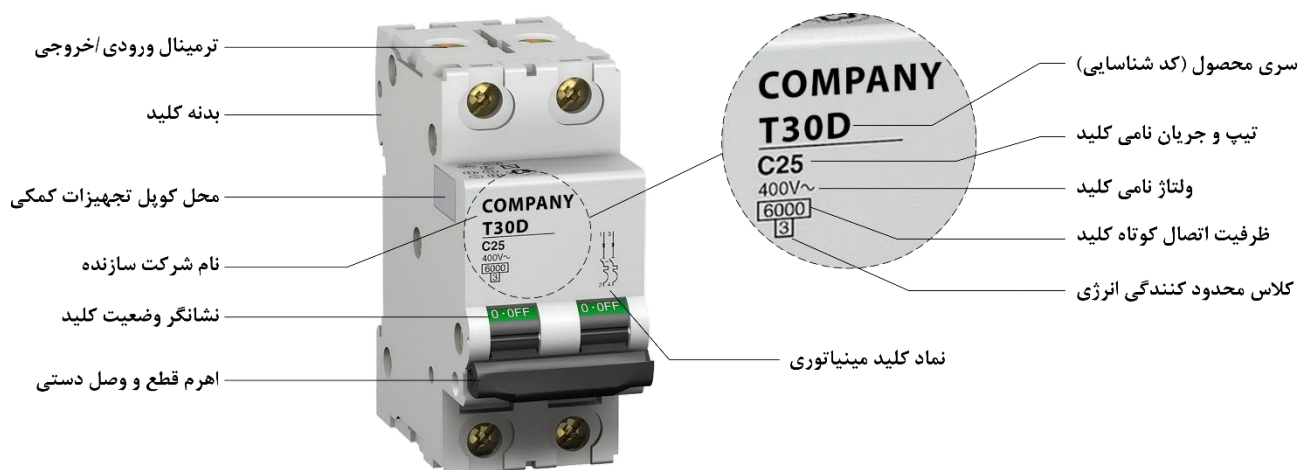
شکل ۶-۳۰- اجزای مختلف کلید مینیاتوری و مشخصات فنی آن
